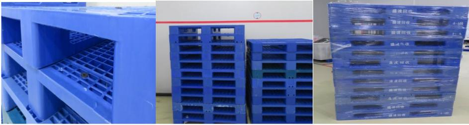
3.7.2 卡板常见验收不合格情况：卡板表面及边角破损、脏污；卡板高度超出标准高度，存在安全隐患；外包装未做防护，表面积尘严重，以下是卡板验收不合格的情况。
