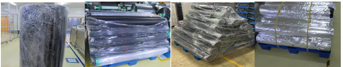
3.6.2 管芯常见验收不合格的情况：管芯表面未做防护处理，表面积尘严重；使用架台放置，导致管芯破损严重；管芯长度未进行分类，外包装未使用保鲜膜进行包裹，表面积尘严重，以下是管芯验收不合格的情况。
