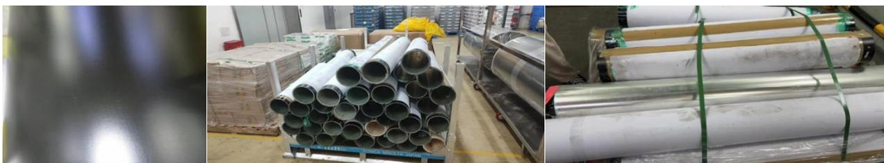
3.7.1 卡板验收合格的情况：卡板表面目视确认表面及边角无破损，无脏污；卡板放置高度 $\leq 1.8$ 米；外包装使用保鲜膜缠绕包裹以免积尘，以下是卡板验收合格的情况。
